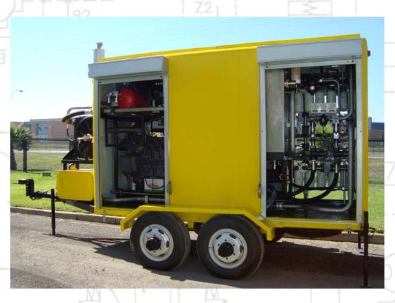
**EXIMTEC** diseña y fabrica equipos de flushing de altísima calidad, confiabilidad y rendimiento para la limpieza o recuperación de circuitos hidráulicos o de lubricación. Los equipos de flushing de **EXIMTEC** garantizan un alto flujo, logrando un número de Reynolds alto, generando así un flujo turbulento necesario para lograr retirar los materiales sólidos adherido en paredes tanto de tuberías como accesorios hidráulicos o de lubricación.
