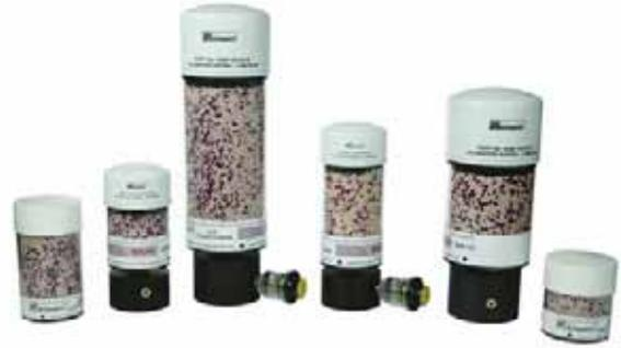
Cuando un reservorio o una transmisión aspira aire, el vapor de agua contenido en el aire se introduce en el sistema. Las fluctuaciones de temperatura harán que el vapor del agua se condense. Esta agua condensada acelerará la oxidación del fluido que resultará en daños al sistema. En el filtro desecante Stauff, primero se seca el aire mientras este pasa por el gel Z-R y, luego, el aire seco pasa a través de un ele-
